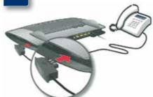
Schließen Sie analoge Telefone an die Buchse "FON 1" und "FON 2" an. Die FRITZ!Box von TNG hat diese Buchse in zwei Ausführungen: hinten für RJ11- und seitlich für TAE-Stecker.
